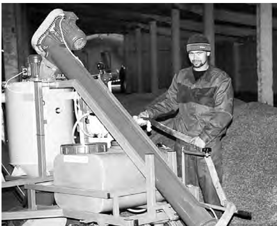
Протравливанием семян на установке ПС-15 занимается Юрий Валерьевич Дрозд.
